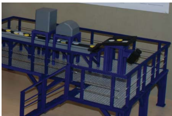
Modell der multifunktionalen Detektions- und Sortierstrecke
