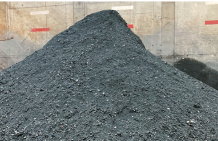
Mineralischer Restanteil der Rostasche nach Schlackeaufbereitung
