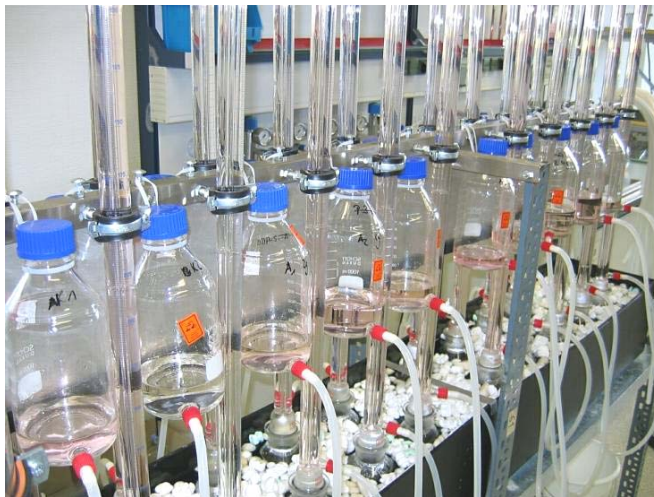
Abbildung 4-3: Eudiometeranlage (links); schematischer Aufbau eines Testansatzes (rechts)
